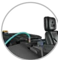
FFF, FimapFastFill per il riempimento rapido del serbatoio soluzione
