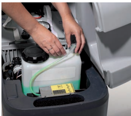
Rapida sostituzione della tanica del detergente nelle macchine dotate dell' Ecoflex Chemical Kit (opzionale)
